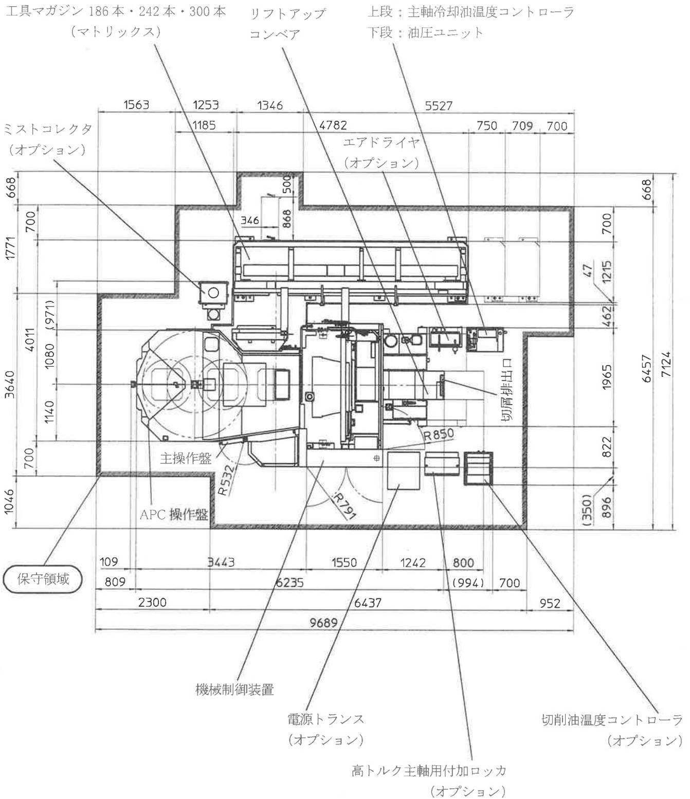
図 2.8 機械上面図 (工具マガジン 186 本・242 本・300 本・後出しコンベア仕様)
