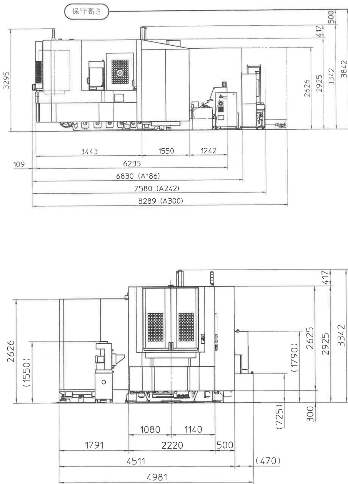
図 2.7 機械側面図・正面図 (工具マガジン 186 本・242 本・300 本・後出しコンベア仕様)
